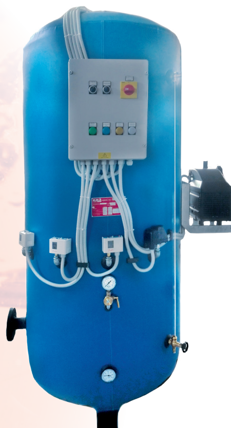
Coibentazione con materassino di polietilene a cellule chiuse anticondensa e espansore per acqua refrigerata, versione in foto con optional installati (pressostato di massima e minima). Isolamento con barriera vapore e finitura esterna in PVC.
